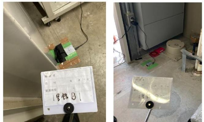
図 2 簡易地震計の設置状況（左：B1、右：8F）
