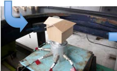
写真2：天秤装置と住宅模型
