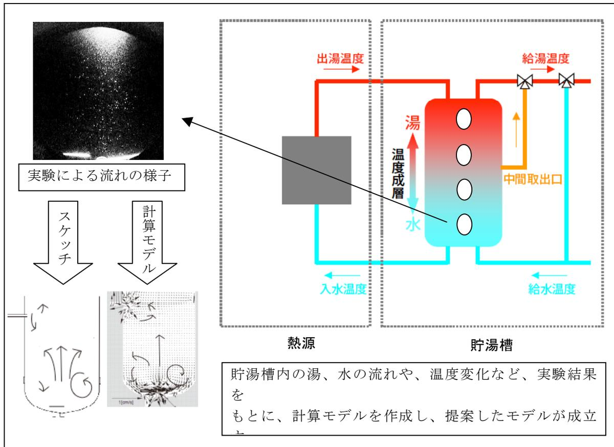
研究成果：実験結果から作成した計算モデルで、実使用時の運転パターンでの貯湯槽内温度分布を計算した結果、提案したモデルで精度よく計算できることが確認できた。
