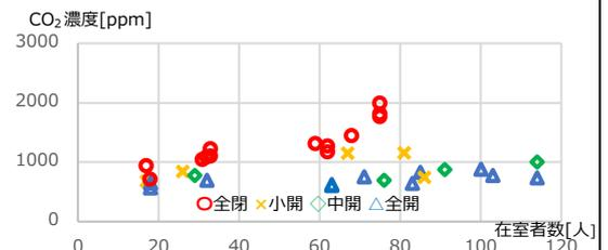
図1 在室者数と窓開けによる二酸化炭素濃度の変化
