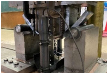
鋼材の曲げ加工
