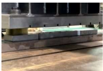
鋼材の曲げ戻し加工
